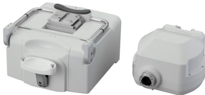
圖 4：NFC-600 可拆卸分離設計
